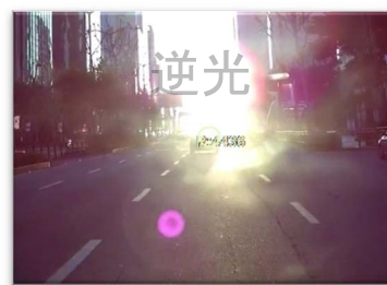
濃霧や逆光時にもミリ波レーダーで前方車両を検知
